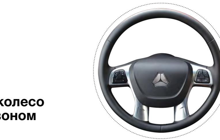
► Многофункциональные переключатели на рулевом колесе обеспечивают и безопасность, и удобство управления: не отрывая рук от него, водитель может управлять магнитолой и круиз-контролем.
