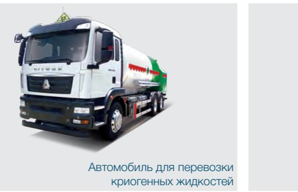
Автомобиль для перевозки криогенных жидкостей
