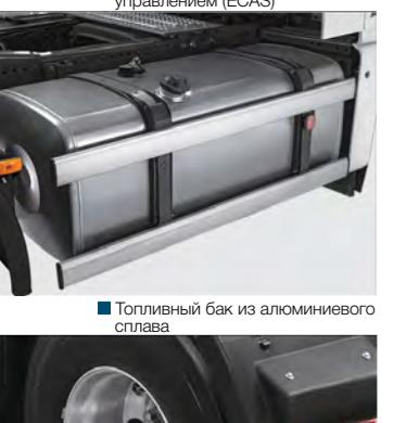
■ Топливный бак из алюминиевого сплава
