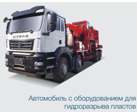
Автомобиль с оборудованием для гидроразрыва пластов
