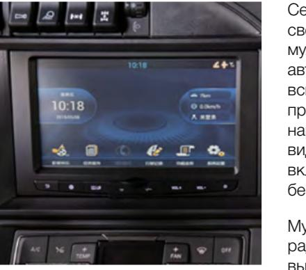
Сенсорный ЖК дисплей с диагональю 6,2 дюйма и светодиодной подсветкой служит для управления функциями мультимедиа. Он также обеспечивает контроль состояния автомобиля с регистрацией результатов и использование вспомогательных функций во время движения, например, предупреждая водителя об опасных ситуациях или нарушениях при управлении автомобилем. Камера заднего вида начинает передавать на него изображение при включении передачи заднего хода для повышения уровня безопасности движения.
