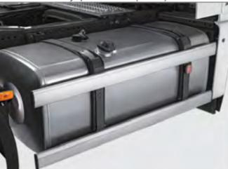
■ Топливный бак из алюминиевого сплава
