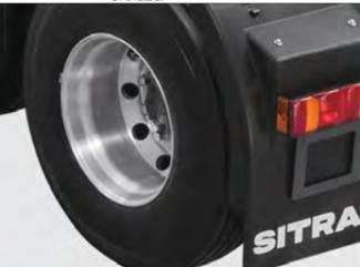
■ Колесный диск из алюминиевого сплава
