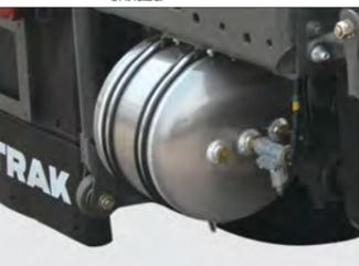
■ Воздушный ресивер из алюминиевого сплава
