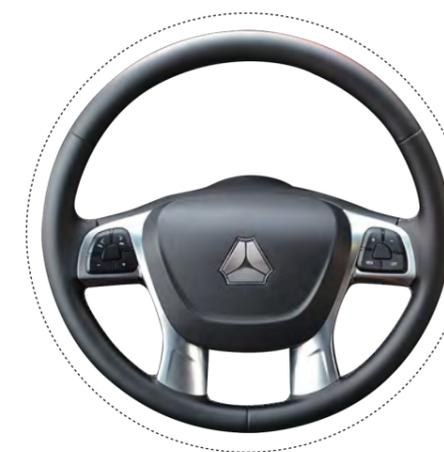
▶ Многофункциональные переключатели на рулевом колесе обеспечивают и безопасность, и удобство управления: не отрывая рук от него, водитель может управлять магнитолой и круиз-контролем.
