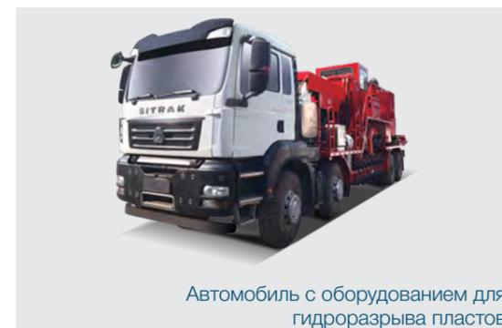
Автомобиль с оборудованием для гидроразрыва пластов
