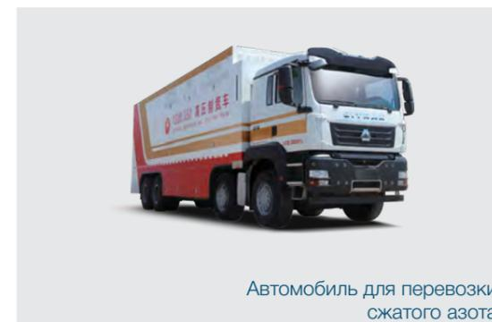
Автомобиль для перевозки сжатого азота
