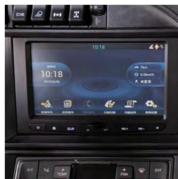
Сенсорный ЖК дисплей с диагональю 6,2 дюйма и светодиодной подсветкой служит для управления функциями мультимедиа. Он также обеспечивает контроль состояния автомобиля с регистрацией результатов и использование вспомогательных функций во время движения, например, предупреждая водителя об опасных ситуациях или нарушениях при управлении автомобилем. Камера заднего вида начинает передавать на него изображение при включении передачи заднего хода для повышения уровня безопасности движения.
